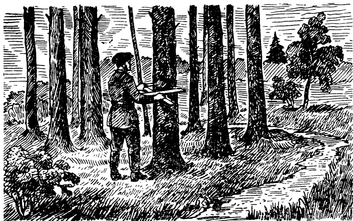
Fig. 19. Determinarea diametrului unui arbore cu ajutorul compasului forestier.
