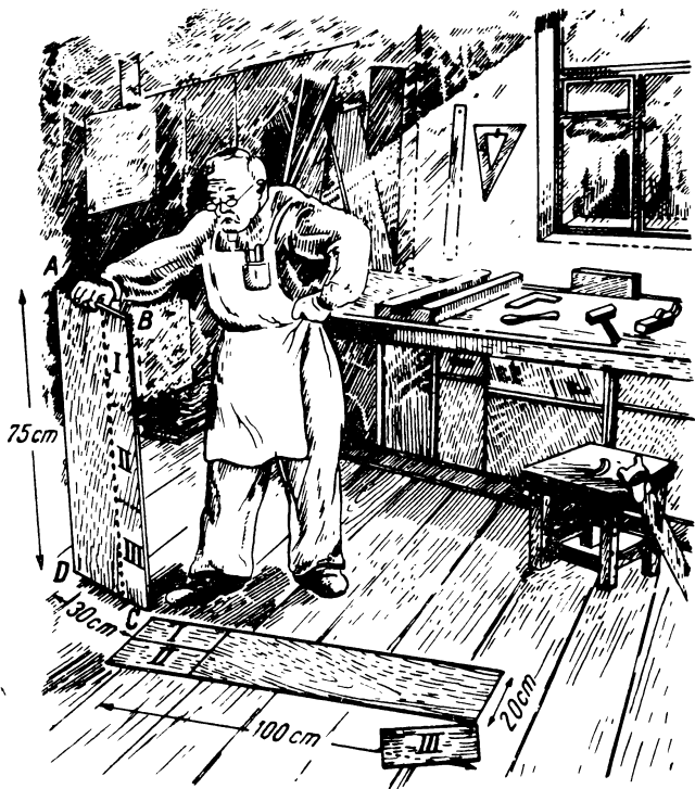
Fig. 177. Cum să lungim scîndura cu ajutorul a trei operații de tăiere și al unei operații de înclieiere?
