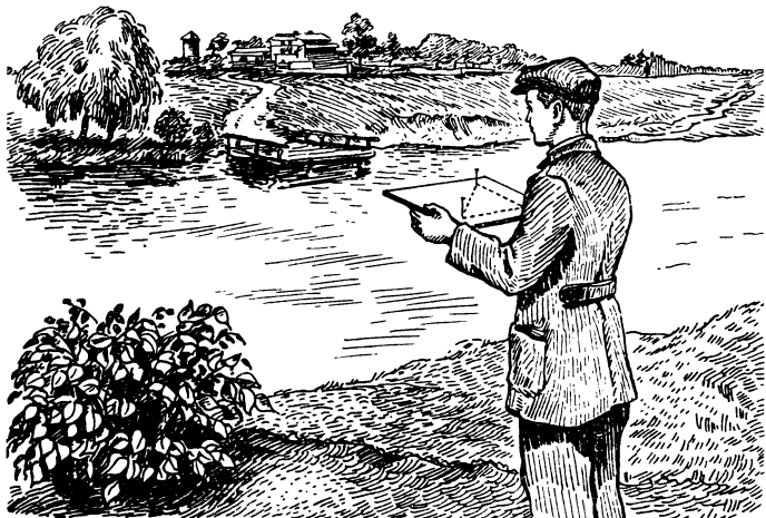
Fig. 25. Determinarea lății unui riu cu ajutorul dispozitivului cu ace.
